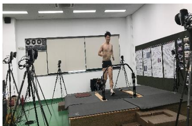
Hình 1. Đánh giá bước chạy cho vận động viên: 8 camera, EMG, băng chuyền phản lực đồng bộ hóa
